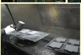
塗装加工 用途に合わせて液体・粉末塗料を生地に吹き付け(乾燥させ) 170℃~400℃で焼成します
