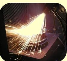
溶射加工 アルミ鍋・アルミステーキ皿・陶製土鍋等に金属を吹き付け電磁調理器対応加工をしています
